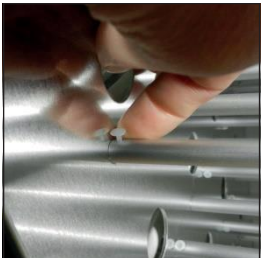
A1. Retirer les clips en plastique côté droit en plastique des tiges d'aluminium
